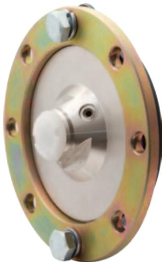
Предназначены для защиты приборов от контакта с агрессивными, кристаллизующимися, несущими взвешенные частицы измеряемыми средами путем передачи давления к средству измерения через разделительный элемент (мембрану) и нейтральную жидкость.
